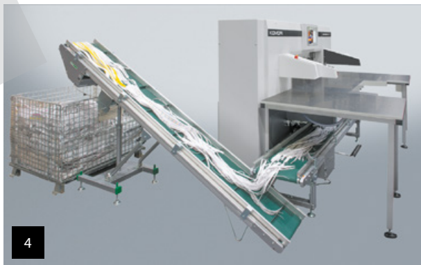
Odpady se automaticky odstraňuje pomocí dopravníkového pásu
