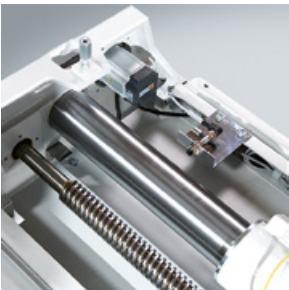
Servopohon pokaždé upraví polohu pro přesné řezání
