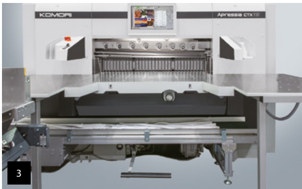
Oddělené zbytky řezu padají dolů
